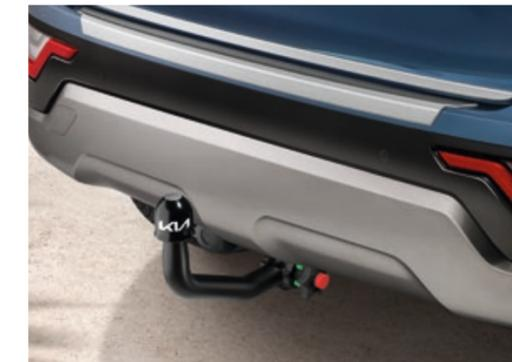
**Abnehmbare Anhängerkupplung.** Wann immer du mehr Platz benötigst, macht es die abnehmbare Anhängerkupplung möglich. Hochwertiger, rostfreier Stahl und die 3-fach Kugelarrretierung sorgen für einfaches, zuverlässiges und sicheres Anschließen von Anhängern aller Art. Bei Fragen zur individuellen Zug- und Stützlast, kontaktiere einfach deinen Kia Händler.
